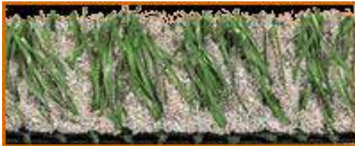
Sandverfüllter PP-KuRa (monofil)
