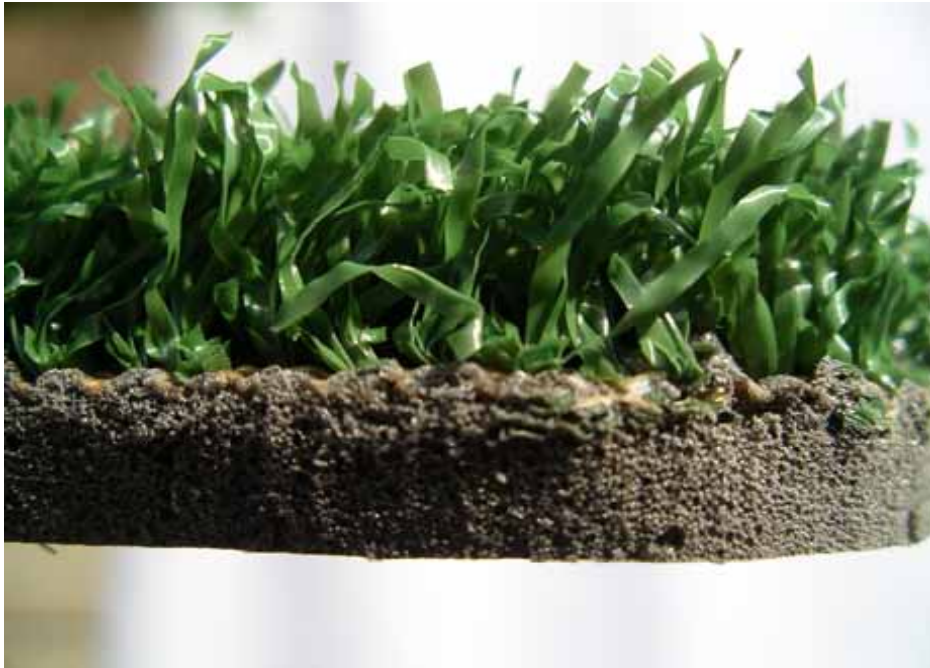
KuRa mit Elastikschicht aus PU-Schaum (ankaschiert)
