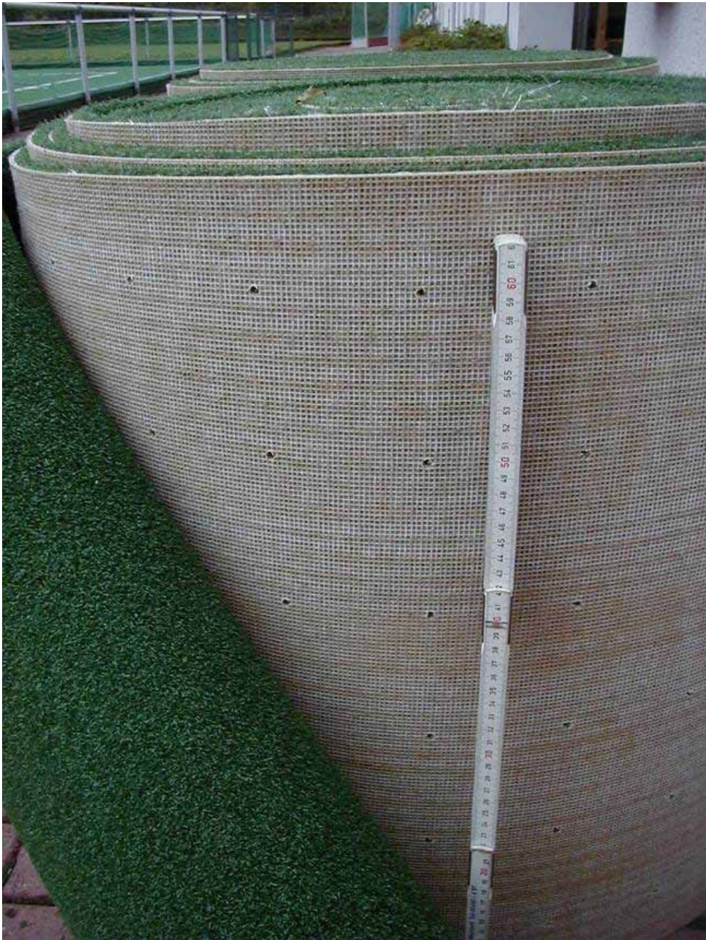
Verstärkter steifer Rücken KuRa ohne Polverfüllung
